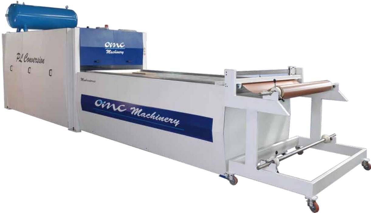
dall'evoluzione del modello PL –conversion ca nasce la pressa a membrana ad aria PL-conversion ca extra con spinta maggiorata. Adatta per il rivestimento con pvc e impiallacciatura da un solo lato
