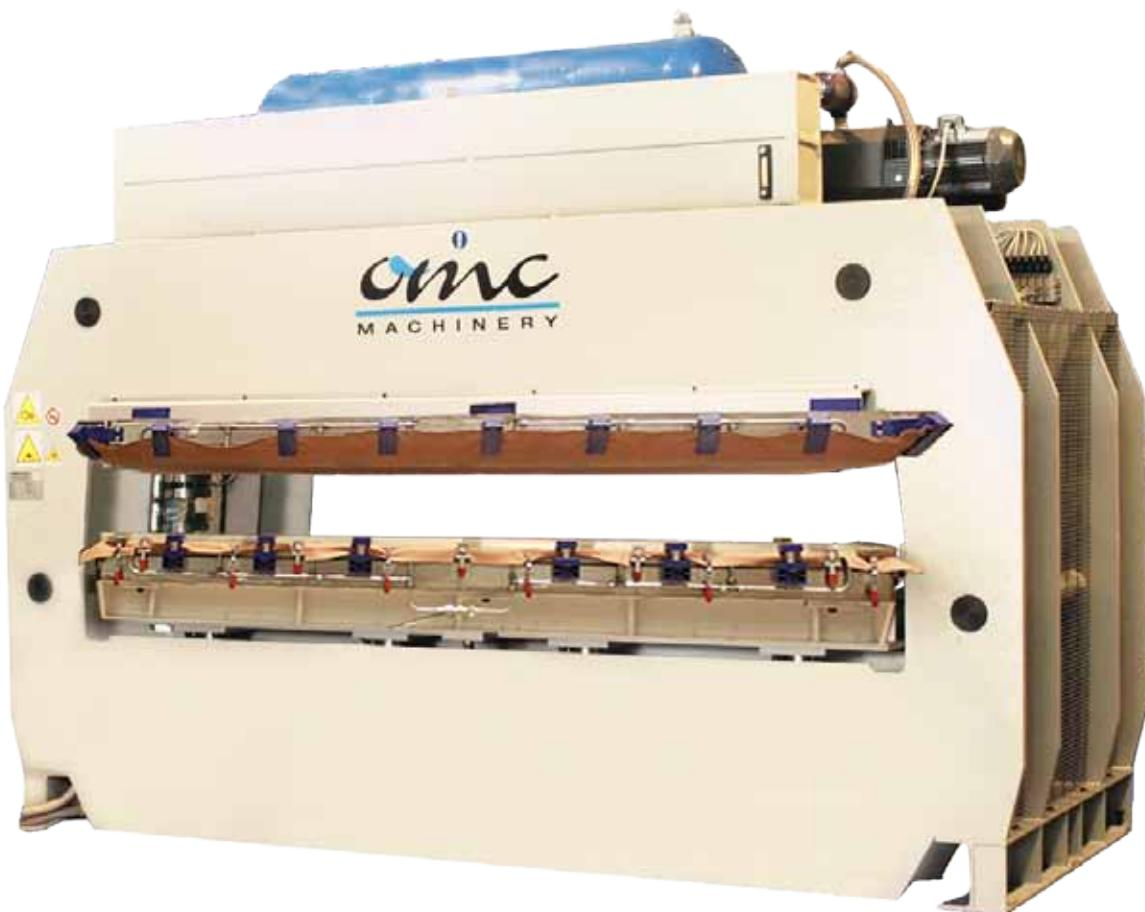
Pressa a doppia membrana ad aria adatta al rivestimento in PVC o impiallacciatura di bugne su due lati. La pompa del vuoto ad alte prestazioni garantisce un ottimo incollaggio. Non dotata di vassoio estraibile.
