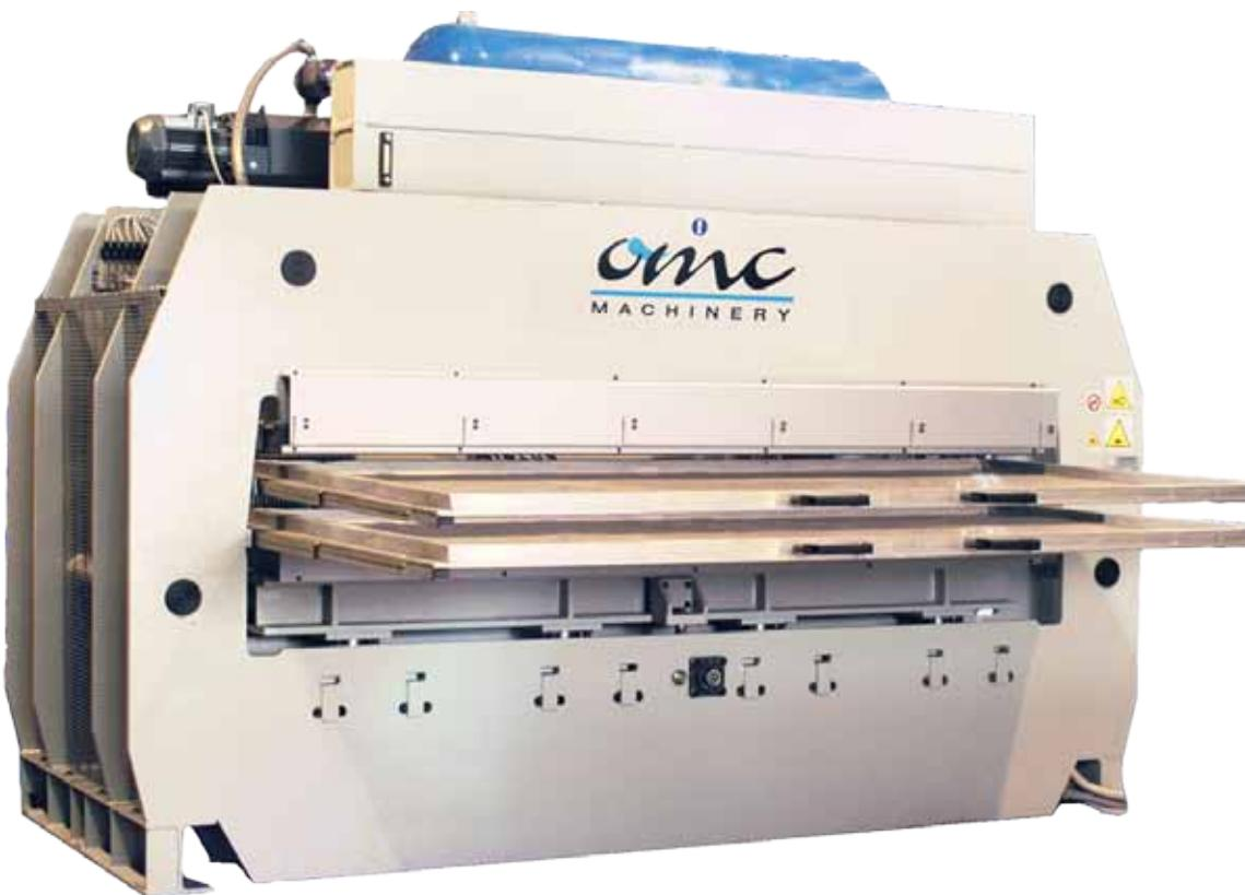
La pressa a membrana ad aria airtec-m può esser dotata di un secondo vassoio per dar vita al modello AIRTEC-m TWO. Con la presenza del secondo vassoio posso preparare il nuovo carico mentre il primo vassoio è in pressata.
