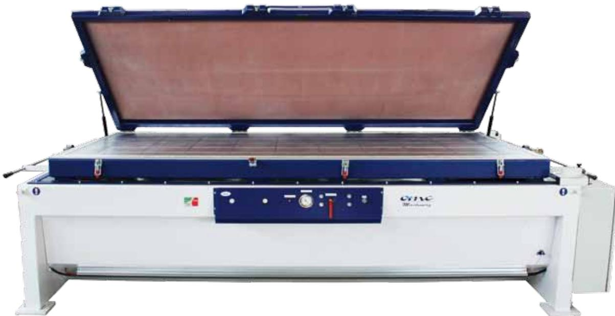
Pressa a membrana a vuoto. Riscaldamento tramite resistenze elettriche alloggiate nel vano inferiore, una volta caricato e azionato il vuoto il piano va ruotato per permettere che le resistenze riscaldino il materiale. Adatta per rivestimento con impiallacciatura o per la creazione di pannelli curvi con sfogliato. Il piano di lavoro è ricavato da una lamiera di alluminio sulla quale sono ricavate delle cave per una uniforme propagazione del vuoto.
