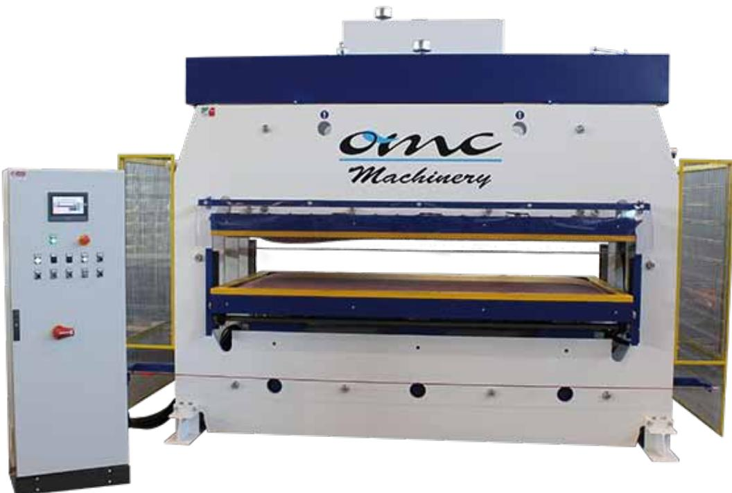
Pressa a doppia membrana a liquido adatta esclusivamente al rivestimento con pvc o impiallacciatura di bugne su due lati. La potenza del liquido garantisce un ottimo prodotto finale. Questa pressa può esser equipaggiata (optional) con un piano di lavoro per usarla anche come una presa a fluido con unica membrana in caso si debbano lavorare pannelli sagomati su un solo lato.
