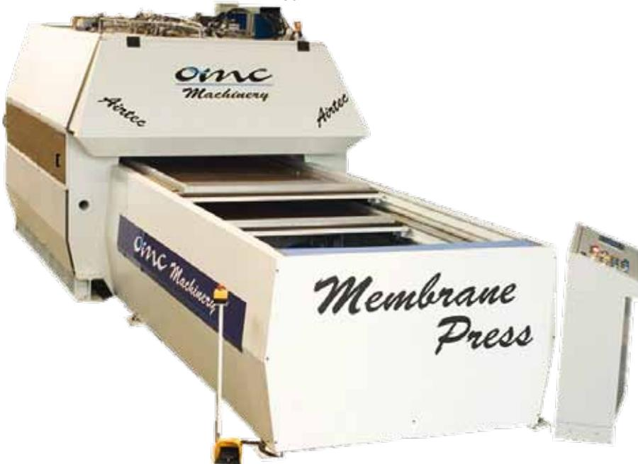
Pressa a membrana ad aria adatta al rivestimento in PVC o impiallacciatura di pannelli sagomati da un solo lato. La pompa del vuoto ad alte prestazioni garantisce un ottimo incollaggio anche nei profili più ostici. La macchina è dotata di vassoio di carico ad estrazione automatica.
