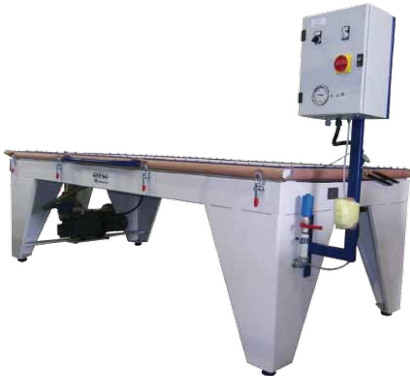
Pressa a membrana a vuoto. Senza impianto di riscaldamento per impiallacciatura o creazione di pannelli curvi con sfogliato. Il piano di lavoro è ricavato da una lamiera di alluminio sulla quale sono ricavate delle cave per una uniforme propagazione del vuoto.
