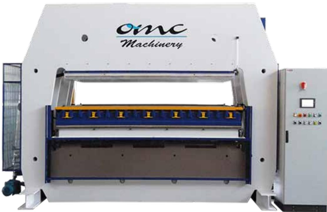
Pressa a membrana a liquido adatta al rivestimento con pvc o impiallacciatura di pannelli sagomati da un solo lato. La potenza del liquido la pompa del vuoto ad alte prestazioni garantiscono un ottimo prodotto finale.
