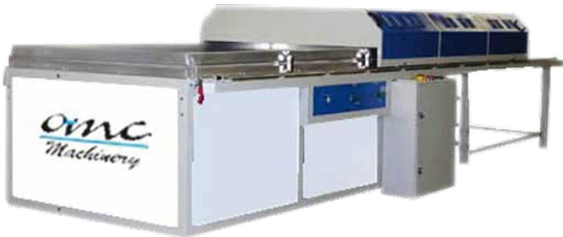
Pressa a membrana a vuoto. Riscaldamento tramite lampade infrarosse poste nel vano scorrevole. Le lampade infrarosse si scaldano molto più velocemente e trasmettono al materiale in lavorazione temperature maggiori rispetto alle tradizionali resistenze elettriche. La pressa è adatta quindi per rivestimento con pvc e carte. Il piano di lavoro è ricavato da una lamiera di alluminio sulla quale sono ricavate delle cave per una uniforme propagazione del vuoto.
