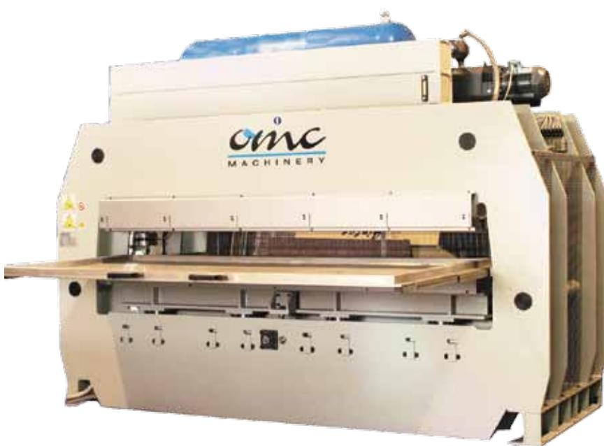
Pressa a membrana ad aria adatta al rivestimento in PVC o impiallacciatura di pannelli sagomati da un solo lato. La pompa del vuoto ad alte prestazioni garantisce un ottimo incollaggio anche nei profili più ostici. La macchina è dotata di vassoio di carico ad estrazione manuale.
