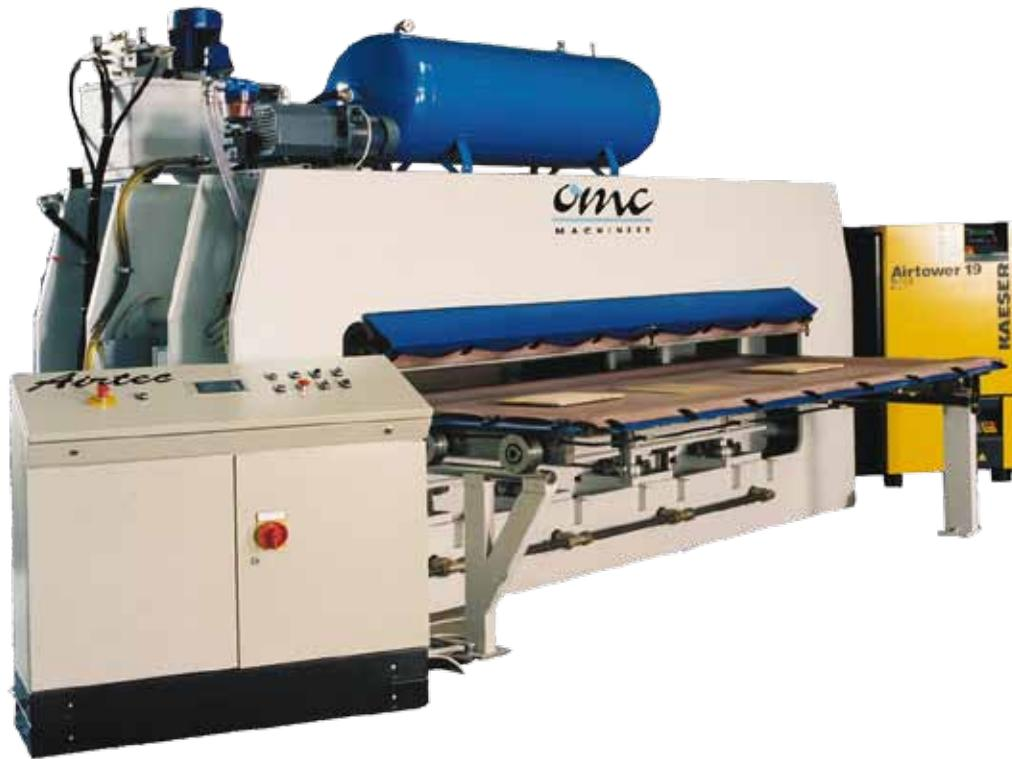
Pressa a doppia membrana ad aria adatta al rivestimento in PVC o impiallacciatura di bugne su due lati. La pompa del vuoto ad alte prestazioni garantisce un ottimo incollaggio. Piano di carico ad estrazione automatica con riscaldamento della membrana elettrico fuori dal vano. Piano mobile inferiore.
