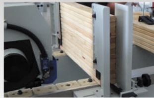
自动送料架 Automatic feeding magazine
