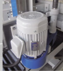
成型系统 Moulding unit 5HP (选配option 7.5HP) 主轴转速Spindle speed: 6000 RPM 主轴尺寸Spindle size.: 40 MM x 120 MM
