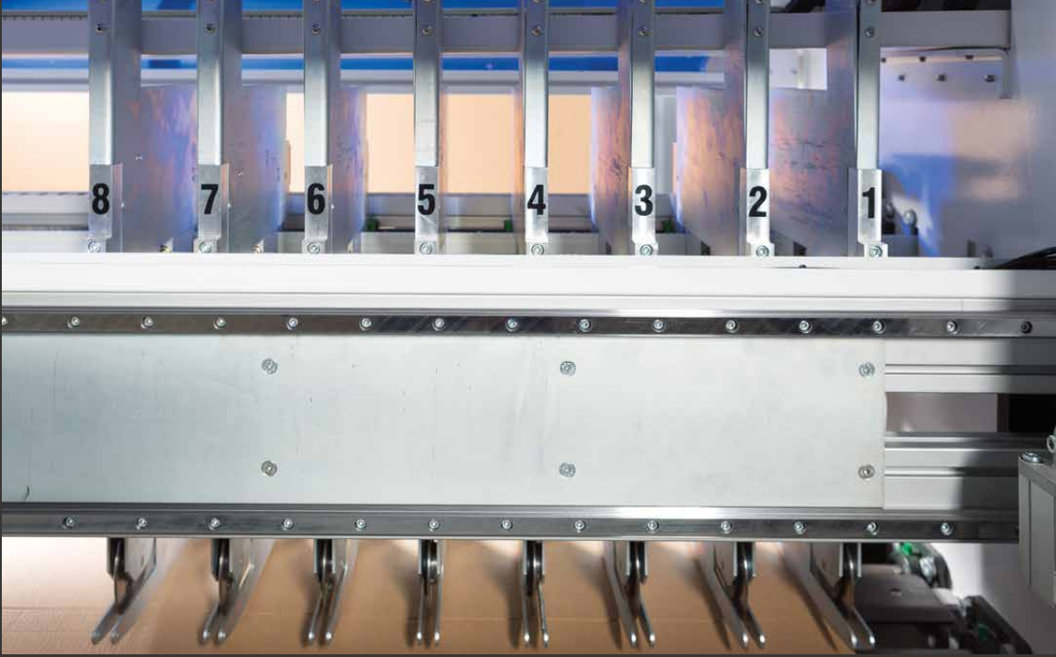
8 Dikey bıçak standart, 16 bıçağa kadar opsiyon 8 Vertical blades standard, up to 16 blades optional
